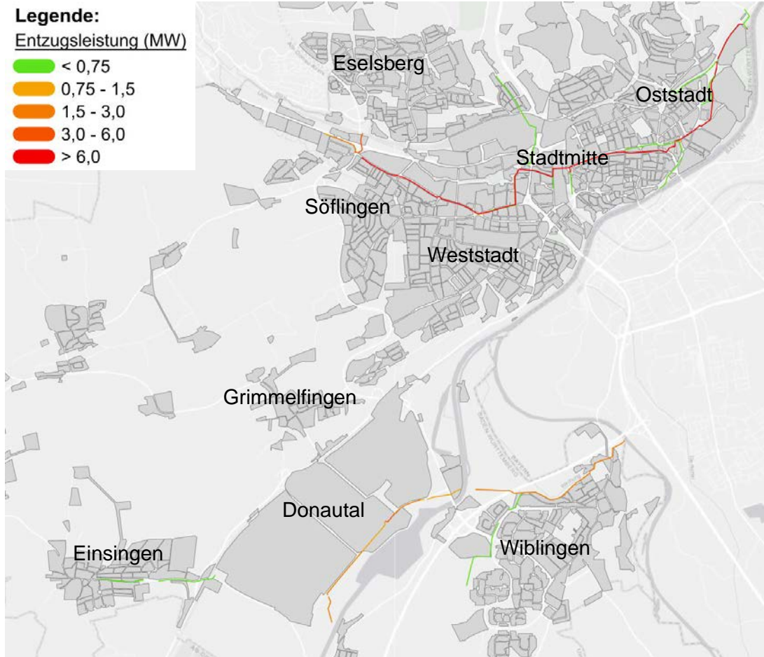
Abb. 34: Abschätzung der Wärmeentzugsleistung aus Abwasserkanälen (Datenquelle: EBU)
