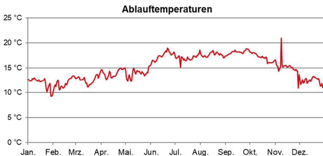
Abb. 35: Vorliegende Ablauftemperaturen nach dem Klärwerk Steinhäule
